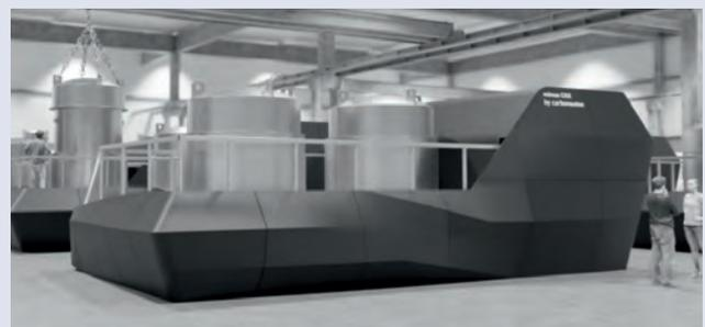
**EIN MODUL BESTEHT AUS WECHSELRETORTEN, PILOTBRENNERN, ÖFEN, EINEM WÄRMESPEICHER UND BIO-ÖLSAMMLER.**
